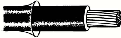
Cable utilizado para lazos inductivos construidos en sitio
